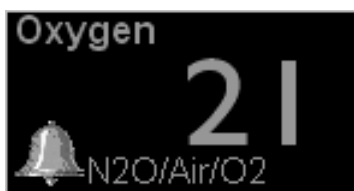
Figure 2-4. N2O/Air/O2 Message in Oxygen Parameter Box
