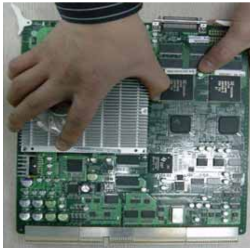
Figure 8-117 Remove a SOM from SYSCONML Assy
