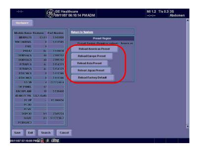
Figure 8-184 Reload buttons
