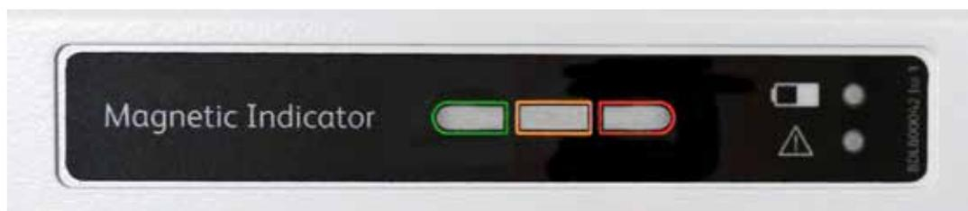
L'indicateur magnétique est un système intégré qui mesure en continu la force du champ magnétique dans l'environnement d'IRM. L'indicateur magnétique est équipé d'alarmes visuelles et sonores. Si le coffret IRM est placé trop près de l'alésage de l'aimant, l'indicateur magnétique déclenche une alarme et les données seront enregistrées. L'indicateur magnétique permet d'indiquer à l'utilisateur si le coffret IRM est placé à une distance de sécurité suffisante de l'alésage de l'aimant.
