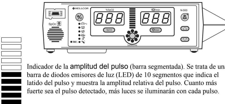
Indicador de la **amplitud del pulso** (barra segmentada). Se trata de una barra de diodos emisores de luz (LED) de 10 segmentos que indica el latido del pulso y muestra la amplitud relativa del pulso. Cuanto más fuerte sea el pulso detectado, más luces se iluminarán con cada pulso.
