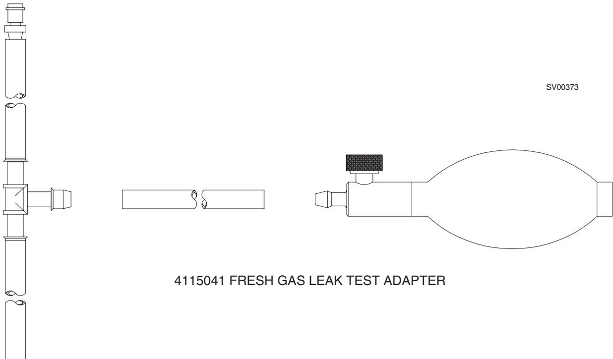
4115041 FRESH GAS LEAK TEST ADAPTER
