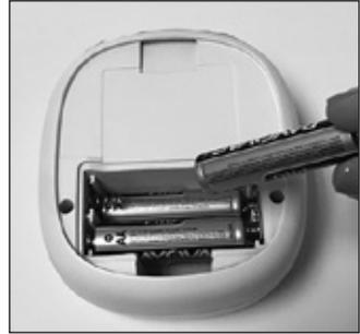
1. **ÖFFNEN** Sie das Batteriefach auf der Unterseite der Pumpenkonsole.
