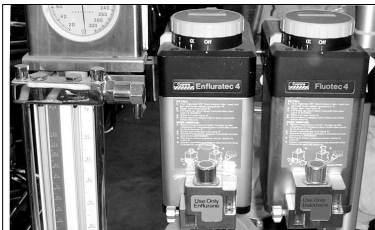
*Deux évaporateurs (pour deux gaz anesthésiques différents) sont placés à la droite du mélangeur et d'un grand manomètre.*
