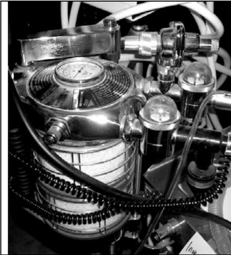
*Cette photo montre le dispositif absorbant le CO<sub>2</sub> (la matière blanche dans le récipient en verre derrière la cage en bas à gauche). Deux vannes se trouvent sous les dômes de verre au milieu à droite.*
