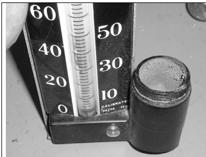
*Sur cette photo, le couvercle du réservoir de mercure a été retiré (à droite). Le mercure s'est oxydé en laissant une poudre fine qui doit être retirée avant de remplir à nouveau le réservoir.*
