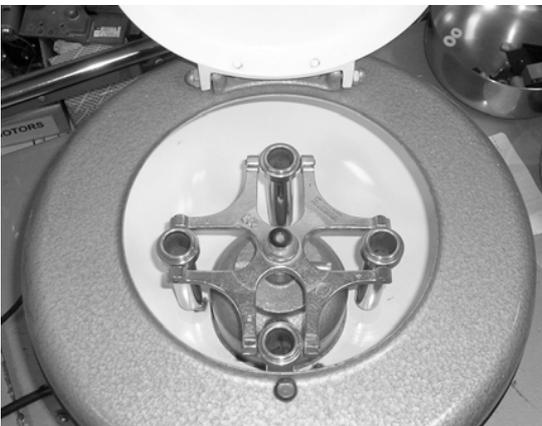
*Avec le couvercle de cette centrifugeuse relevé, vous pouvez voir les quatre supports dans lesquels les tubes d'échantillons ou les tubes d'équilibrage seraient placés. Lorsque le rotor tourne, les tubes pencheront sous un certain angle. Le petit rond point juste au-delà de l'intérieur blanc (centre bas) est un dispositif de verrouillage qui empêche l'appareil de tourner si le couvercle est ouvert.*
