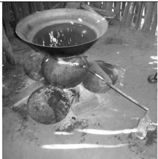
*Les alambics n'ont pas besoin d'être sophistiqués. Ici, un simple pot est tenu au feu et couvert par un grand bol d'eau. Trois roches tiennent le pot en place. Le long tube permet de condensation. Le condensat tombe dans le récipient de collecte dans le coin en bas à droite.*
