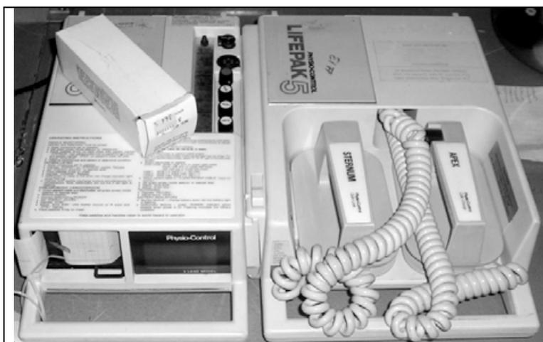
*Les défibrillateurs manuels sont couramment disponibles dans les pays en développement. L'unité à gauche comprend un moniteur ECG. L'appareil délivre un choc potentiellement mortel et doit être utilisé avec beaucoup de soin.*
