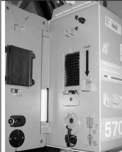
*Une pompe péristaltique linéaire utilise des doigts (roller, à côté de la grosse flèche noire) qui "traient" le liquide le long de la tubulure. Une tubulure spéciale est en principe requise, ce qui rend ce genre de pompe moins populaire dans les pays en développement.*
