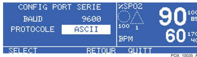
5. Utiliser les touches AUGMENTER et DIMINUER pour sélectionner le protocole souhaité. Les options de protocole relatives au sphygmo-oxymètre OxiMax N-600x diffèrent de celles de l'oxymètre dont la fonction SPD est activée. Le protocole par défaut d'usine est ASCII. Voir *Compatibilité avec les protocoles de communication et sortie*, page 90.
