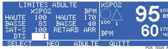
2. Utiliser la touche AUGMENTER pour sélectionner une valeur moins sensible pour les tracés de désaturation et qui diminue le nombre d'alarmes. La valeur 3 correspond au paramètre le moins sensible pour les tracés de désaturation.
