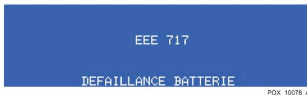
Lorsqu'un code d'erreur différent de ceux indiqués au Tableau 17 page 122 s'affiche, mettre l'oxymètre hors tension puis de nouveau sous tension. Si le code d'erreur réapparaît, le noter et avertir le technicien qualifié. Le cas échéant, l'appareil interrompt le monitoring, supprime toutes les informations à l'écran et affiche le message « EEE XXX », puis émet une alarme de faible priorité. Interrompre et rétablir l'alimentation électrique efface ces erreurs.
