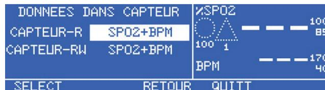
4. Utiliser la touche de fonction SELECT pour basculer entre les fonctions CAPTEUR-R (capteur contenant une puce en lecture seule) et CAPTEUR-RW (capteur contenu une puce en lecture/écriture).
