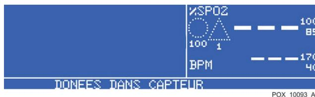
Si les données du capteur d'oxymétrie pulsée OxiMax sont encore en cours de lecture au bout de quatre à six secondes, le message DONNEES DANS CAPTEUR est remplacé par un message LECTURE TENDANCES avec une option ANNULER.
