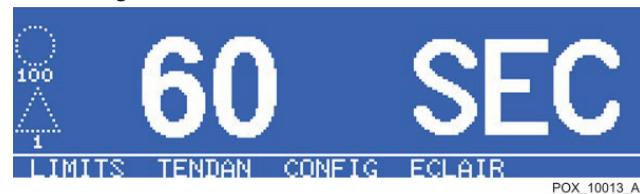
2. Appuyer sur la touche NEUTRALISATION D'ALARME et sur la touche AUGMENTER située sous la touche NEUTRALISATION D'ALARME sur le panneau de l'oxymètre et les maintenir enfoncées pour augmenter la durée de neutralisation.
