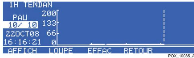
La mesure UAP (16 : 16) indique les unités d'amplitude du pouls (supérieures et inférieures) à l'emplacement du curseur (ligne pointillée). Le curseur se déplace vers la droite ou vers la gauche à l'aide de la touche AUGMENTER (droite) ou DIMINUER (gauche).
