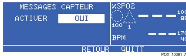
4. Appuyer sur la touche AUGMENTER ou DIMINUER sous la touche NEUTRALISATION D'ALARME sur l'oxymètre pour activer ou désactiver les messages.
