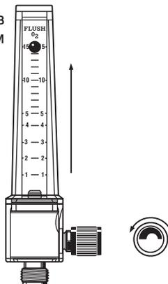
4. Поверните ручку регулировки потока по часовой стрелке (в сторону уменьшения), чтобы перекрыть поток.
