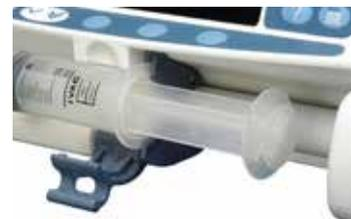
4. Relever le clamp de détection de la taille de la seringue jusqu'à ce qu'il se bloque contre le corps de la seringue.
