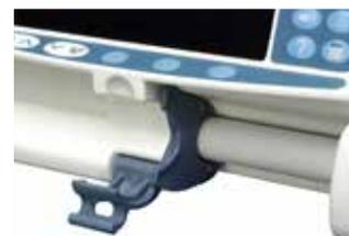
3. Installer la seringue en s'assurant que la collerette du piston est placée dans l'encoche du clamp de la collerette.
