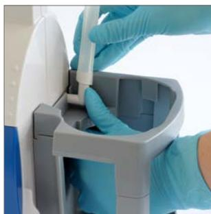
2. Coloque el contenedor externo Serres® en posición vertical en el soporte. La escala debe quedar visible.
