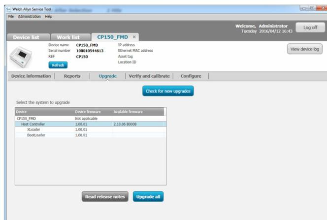
9. Mettre en surbrillance le logiciel de l'appareil (par exemple, le micrologiciel Host Controller 2.XX. XX) à sélectionner dans la liste.
