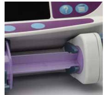
7. S'assurer que le type et la taille de seringue correspondent à ceux affichés sur le pousse-seringue Alaris® Enteral puis appuyer sur **CONFIRMER**. Si nécessaire, le type de seringue peut être modifié en appuyant sur la touche **TYPE**.
