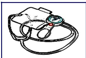
**1.3.2 Esfigmomanómetro aneroid.** Este dispositivo tiene las mismas características del mercurial pero en lugar de un manómetro de mercurio utiliza un mecanismo aneroid, lo que lo hace más ligero y transportable. Debido a que los manómetros aneroides son dispositivos con un mecanismo a base de resortes, requieren de una constante revisión de la calibración ya que con el uso y desgaste del mecanismo puede dar como resultado una lectura incorrecta.
