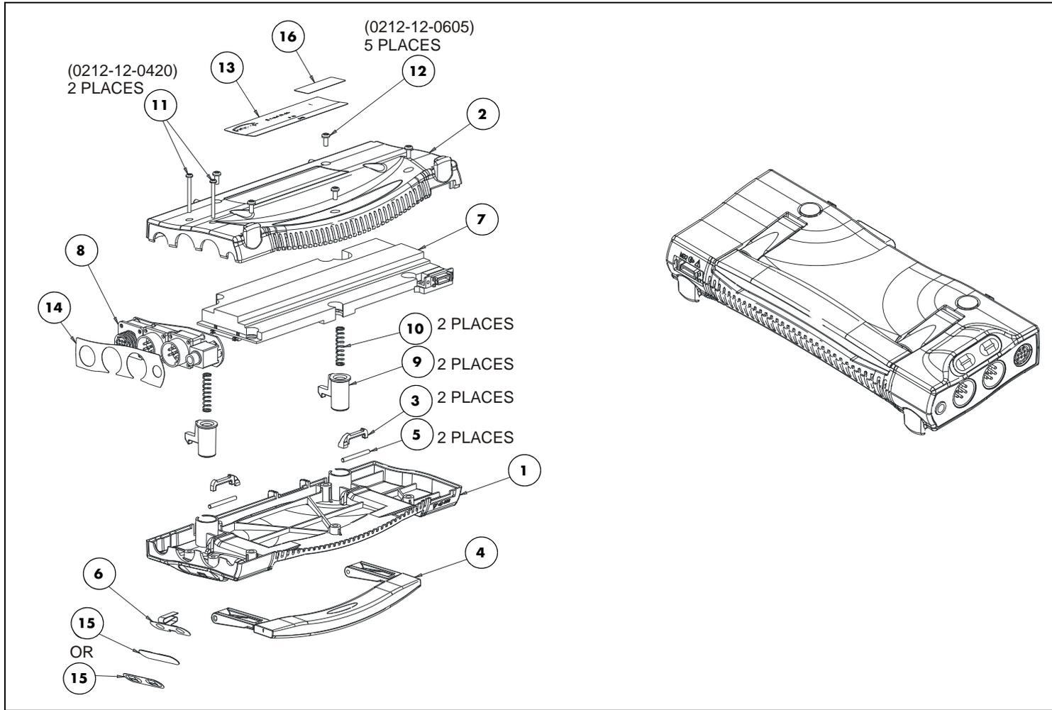
**FIGURE 3-19** External Parameter Module
