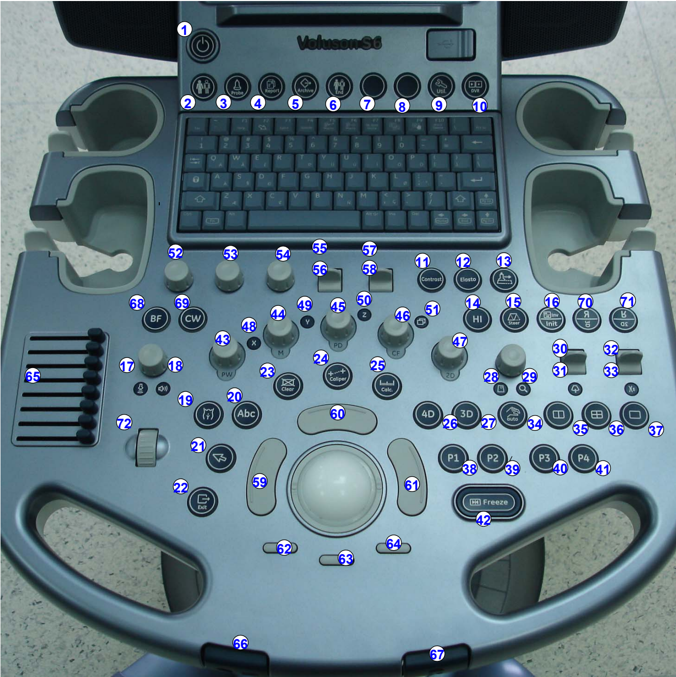
Figure 5-15 Voluson™ S8 / Voluson™ S6 - OPIO Layout
