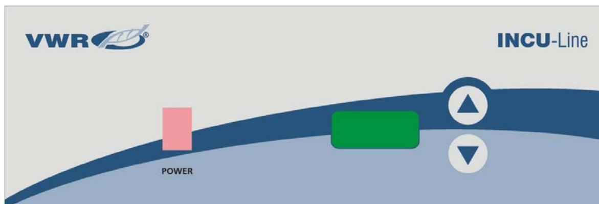
POWER - interruttore di alimentazione: Per accendere l'incubatore ON e OFF. Il pulsante power brilla quando l'incubatore è acceso.
