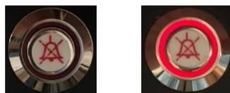
Figure 14.9 La touche d'alarme indiquant la condition d'alarme
