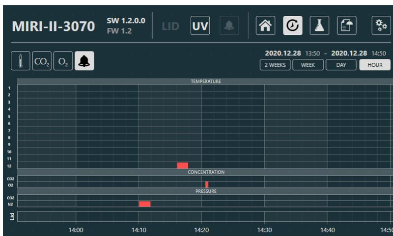
Figure 20.4 Aperçu des alarmes de température, de concentration et de pression
