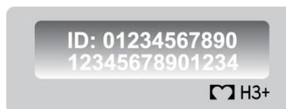
Pour terminer l'enregistrement prématurément, la pile peut être retirée de l'enregistreur pour stopper l'enregistrement. La réinsertion de la pile affichera l'ID en couleur inverse tel que montré ci-dessus.
