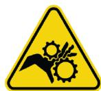
Hareketli Parça Sembolü, bölgede hareketli parçalar olduğunu ve kişisel yaralanma risklerini azaltmak için sistemin yalnızca tüm kapaklar yerindeyken ve dikkatli bir şekilde kullanılması gerektiğini belirtir. Kapakların düzgün oturtulmaması halinde, hatalı sonuçlar oluşabilir. Hareketli parçalar örnek probu, reaktif problemleri, şırınga parçaları, karıştırıcı çubuklar vb. olabilir.
