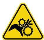
Das Symbol für bewegliche Teile kennzeichnet, dass der betreffende Bereich bewegliche Teile enthält und das System nur betrieben werden darf, sofern sämtliche Abdeckungen angebracht sind. In solchen Bereichen ist besonders vorsichtig vorzugehen, um die Gefahr von Verletzungen zu reduzieren. Eine unsachgemäße Anbringung der Abdeckungen kann fehlerhafte Ergebnisse nach sich ziehen. Zu beweglichen Teilen zählen die Probennadel, die Reagenzienadeln, Teile der Spritzen, Mischerstäbe usw.
