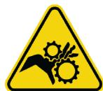
Il simbolo Parti in movimento indica che nell'area sono presenti delle parti in movimento, che il sistema deve essere utilizzato solo dopo aver chiuso tutti i coperchi e che è necessario fare attenzione per ridurre il rischio di lesioni personali. Se i coperchi vengono posizionati in modo errato, i risultati potrebbero essere errati. Tra le parti in movimento vi sono la sonda campionatrice, le sonde dei reagenti, le parti delle siringhe, le barre di miscelazione ecc.
