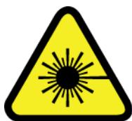
O símbolo de radiação laser indica que pode haver radiação de luz laser na área. Adote precauções apropriadas para evitar a exposição.
