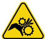
「可動零件符號」表示該區域有可動零件，而且只能在所有外蓋均已固定在正確位置且小心注意的情況下操作本系統，以降低個人傷害的風險。未正確地安裝外蓋可能會導致錯誤結果。可動零件可能包括檢體探針、試劑探針、注射器零件、混合器攪拌棒等。
