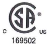
Dieses Symbol steht für die Anerkennung durch eine staatlich anerkannte Prüfstelle und belegt, dass das Instrument den entsprechenden Sicherheitsstandards der Vereinigten Staaten und Kanadas entspricht.
