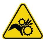
A mozgó alkatrészek szimbólum azt jelenti, hogy az illető területen mozgó részek vannak, és a rendszert csak úgy szabad működtetni, hogy minden fedél a helyén van, és a kezelő körültekintően jár el a személyi sérülés kockázatának csökkentése érdekében. A fedelek nem megfelelő elhelyezése hibás eredményeket okozhat. A mozgó alkatrészek közé tartozhat a mintavételi tű, a reagenszondák, a fecskendők részei, a keverőrudak stb.
