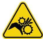
Symbolet for bevægelige dele indikerer, at der er bevægelige dele i området, og at systemet kun bør betjenes, når alle afdækninger er på plads, og der udvises forsigtighed for at reducere risikoen for personlig tilskadekomst. Påsættes afdækninger ikke korrekt, kan det føre til fejlagtige resultater. Bevægelige dele kan indbefatte prøveproben, reagensprober, sprøjtedele, blandestænger osv.
