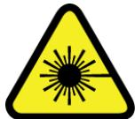
Das Symbol für Laserstrahlung zeigt an, dass es in diesem Bereich Laserstrahlung geben kann. Vorsichtsmaßnahmen treffen, um Exposition zu vermeiden.
