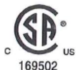
Этот символ указывает на то, что, по мнению Национальной испытательной лаборатории США, прибор отвечает соответствующим стандартам безопасности изделия для США и Канады.
