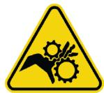
O símbolo de peças em movimento indica que existem peças em movimento na área e que o sistema deve ser operado apenas quando todas as tampas estiverem devidamente colocadas, tendo cuidado de forma a reduzir riscos de lesões. Se as tampas não forem corretamente colocadas, tal poderá dar origem a resultados errados. As peças em movimento podem incluir a pipeta de amostra, pipetas de reagente, peças de seringas, agitadores, entre outros.
