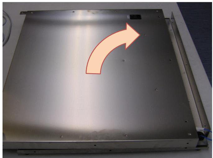
Verschrauben Sie die beiden Teile von hinten mit drei Schrauben ⑧. Verwenden Sie hierzu den Schraubendreher ⑨. Drehen Sie die Teile auf der Arbeitsfläche um 90° und kippen Sie die beiden verschraubten Teile auf die hintere Fläche der Rückwand ②. Verschrauben Sie die beiden Teile zusätzlich von der Bodenseite aus mit zwei Schrauben ⑧. Kippen Sie die nun fertig verschraubten Teile wieder zurück und drehen Sie sie mit der Rückwand nach hinten.
