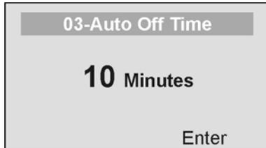
El usuario puede determinar cuanto tiempo la balanza operará antes de automáticamente apagarse debido a inactividad. El tiempo predeterminado es de 10 minutos. Si el valor es establecido como cero, la función Apagar Automático es desactivada.
