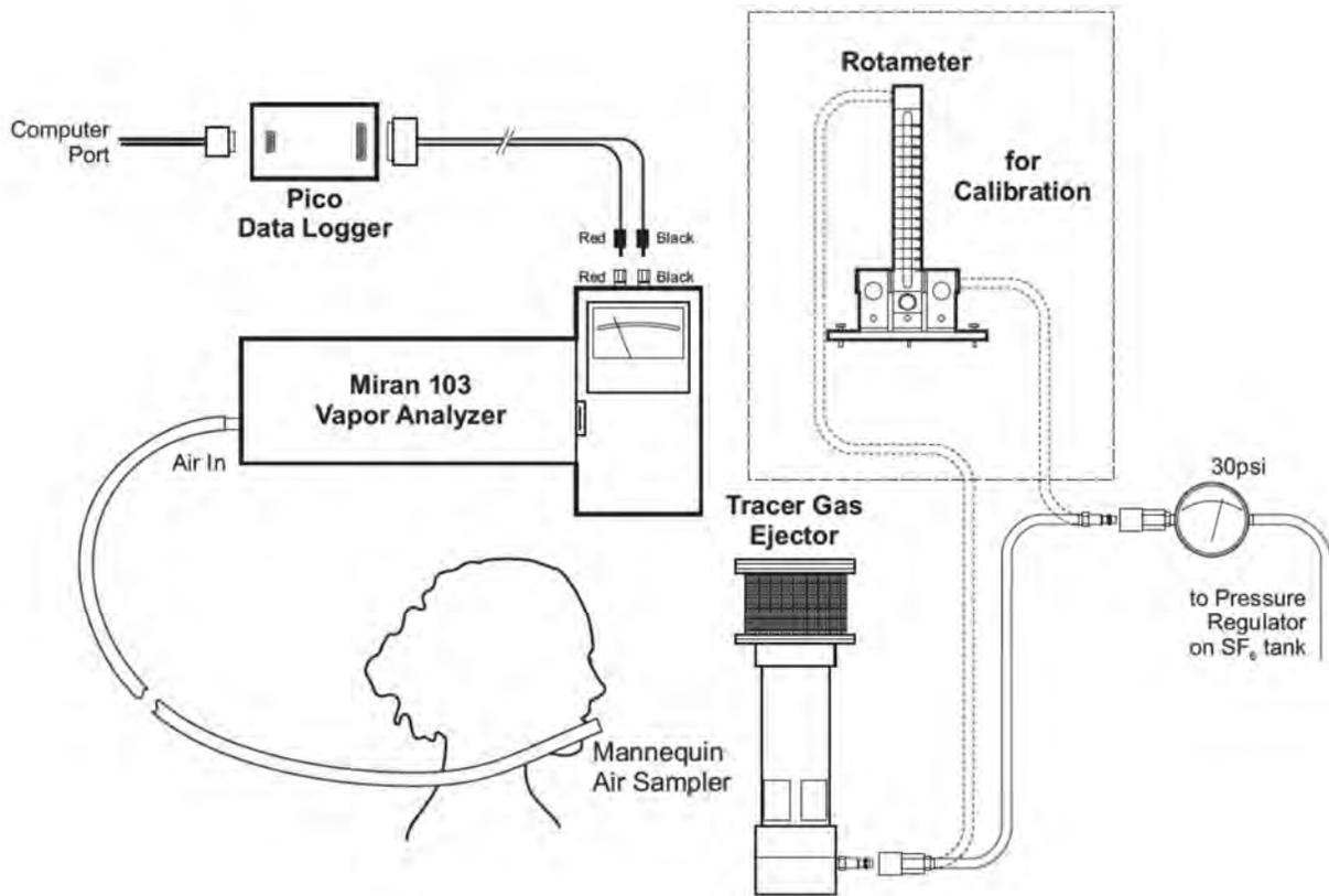
**TRACER GAS TESTING PROCEDURE**
