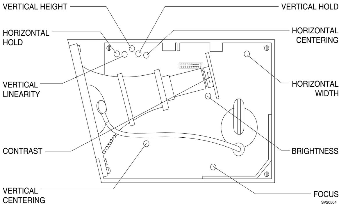
**Figure 5-1A: WELLS GARDNER CRT ADJUSTMENTS (LATER MODELS)**
