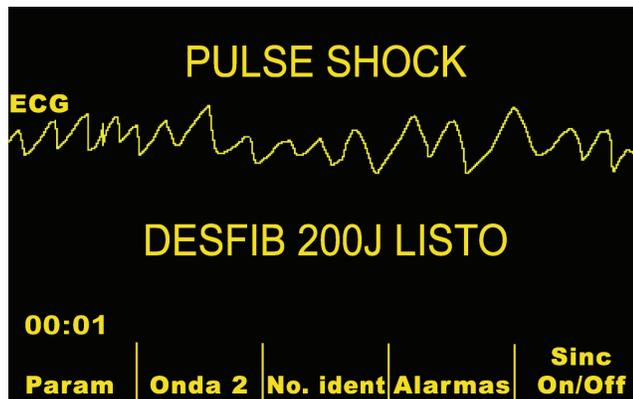
Se escuchará un tono continuo durante 50 segundos, seguido de un pitido intermitente durante 10 segundos. El shock se debe administrar durante este intervalo de 60 segundos sino el desfibrilador se desactivará.
