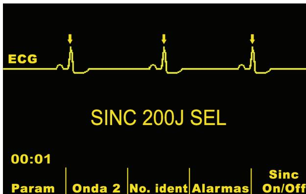
Los parches multifunción pueden servir de fuente del ECG ya que ofrecen una calidad de señal similar a la de las derivaciones de ECG.
