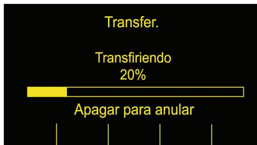
6. Si la transmisión tiene éxito, la unidad mostrará la pantalla Tarjeta transferida. Para cargar otra tarjeta, extraiga la actual, inserte una nueva y pulse de nuevo la tecla suave Enviar. (La tecla suave Enviar aparece cuando se inserta una nueva tarjeta).
