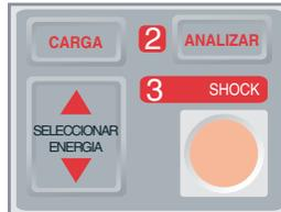
Una vez que se administre la energía, la pantalla mostrará los mensajes "XXXJ DESCARGA" y "DESFIB XXXJ SEL" simultáneamente. Después de aproximadamente 5 segundos, desaparecerá el mensaje "XXXJ DESCARGA" y permanecerá el mensaje "DESFIB XXXJ SEL" para indicar el nivel de energía seleccionado.
