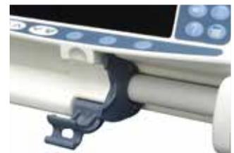
3. Installer la seringue en s'assurant que la collerette du piston est placée dans l'encoche du clamp de la collerette.
