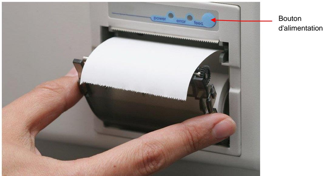
Figure 48 – Insertion du rouleau de papier dans l'imprimante
