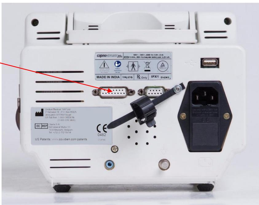
Figure 43 – Le port analogique du Capnostream™20p
