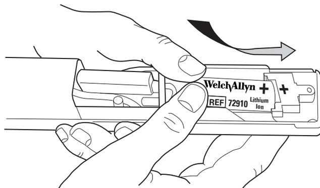
4. Remettre le couvercle en place en insérant l'extrémité de la sonde sous l'avant, puis abaisser l'extrémité opposée et remettre la vis en place.
