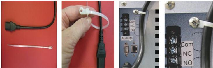
Installation d'une décharge de traction pour le cordon d'alimentation sur les modèles sous comptoir
