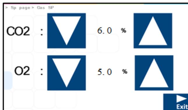
**Figura 13.13** Vista del valor programado del gas de la incubadora multicámara FIV MIRI® TL6
