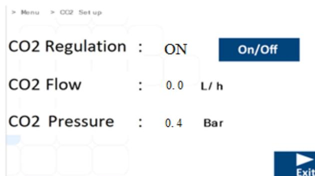
Figura 13.25 Vista del Submenú de CO<sub>2</sub> en la incubadora multicámara FIV MIRI® TL6 y MIRI® TL12
