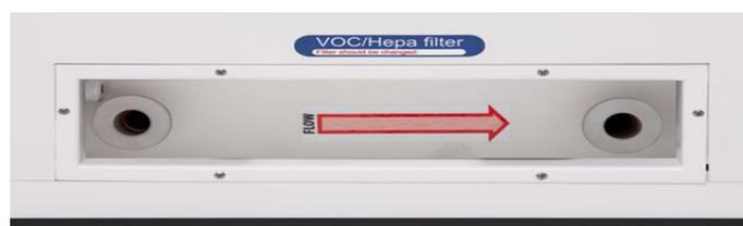
Figura 12.1 Flecha de flujo de la incubadora multicámara FIV
