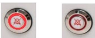
Figura 14.1 Tecla de alarma que indica el estado de alarma
